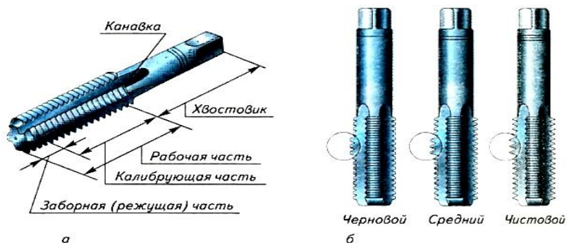
Рис. 81. Метчики: а — основные элементы; б — комплект для нарезания метрической резьбы
