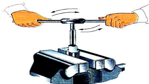
Рис. 82. Нарезание резьбы метчиком
